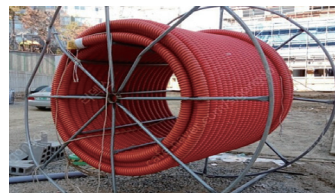
〈통신용 COD(Cable Optical Duct)관〉
