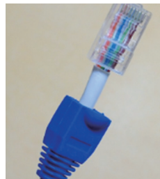
〈UTP(꼬임케이블, Unshielded twisted pair cable)〉
