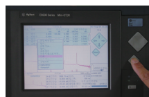
〈OTDR 측정 및 결과값 프린트〉
